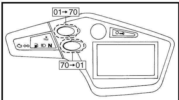
4. Pulse el botón "SELECT" para seleccionar la función de ajuste de CO "Co" o la función de diagnóstico "diag".
